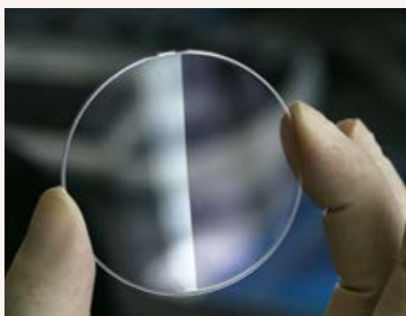
3 Defektfrei nanostrukturierte PC Scheibe (Struktur nur auf der rechten Hälfte der Scheibe). | Defect-free nanostructured PC disk (structure only on the right half).
